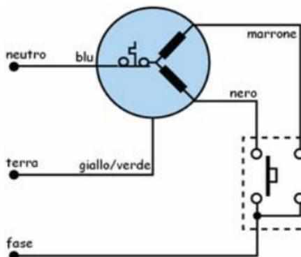
Collegare il punto di comando necessario per la programmazione (doppio pulsante **non interbloccato**). Se il senso di rotazione non è corretto invertire i fili marrone e nero del motore.
